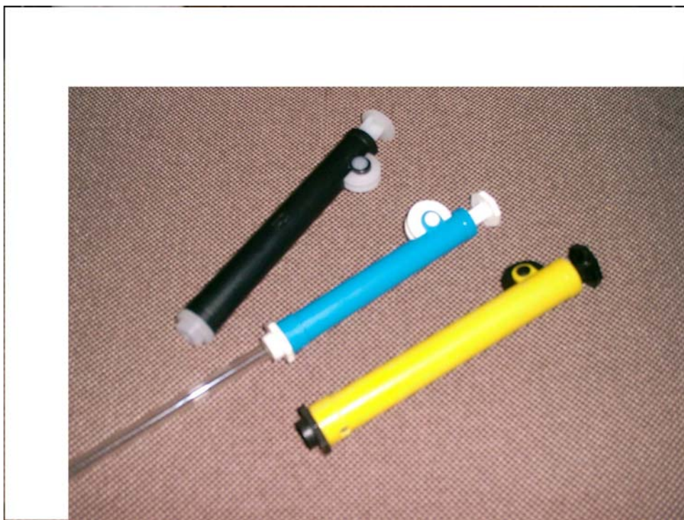
Рис.3 внешний вид насосов-дозаторов НДМ-02 и НДМ-10
