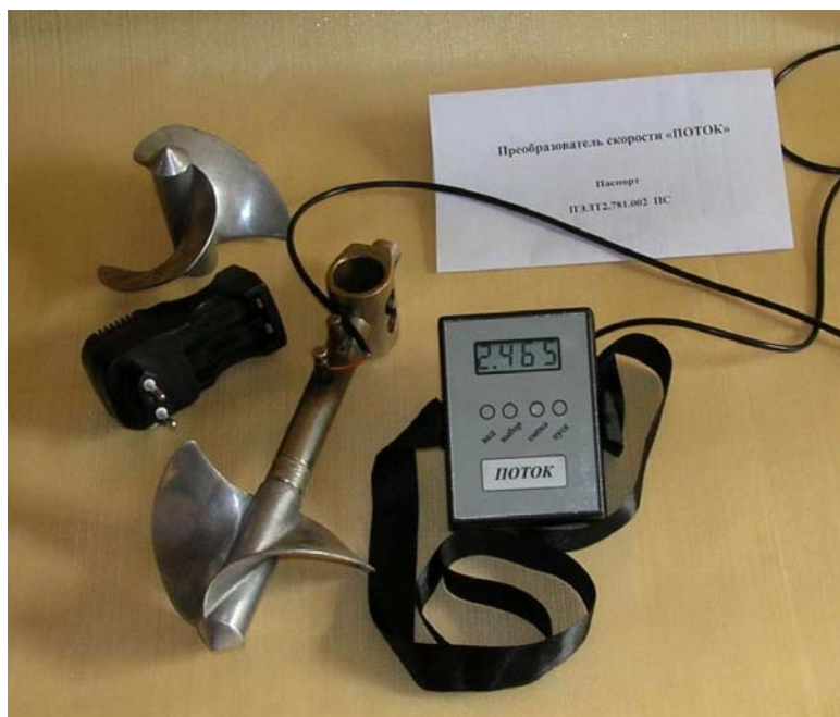
Внешний вид прибора с вертушкой ГР-21М
